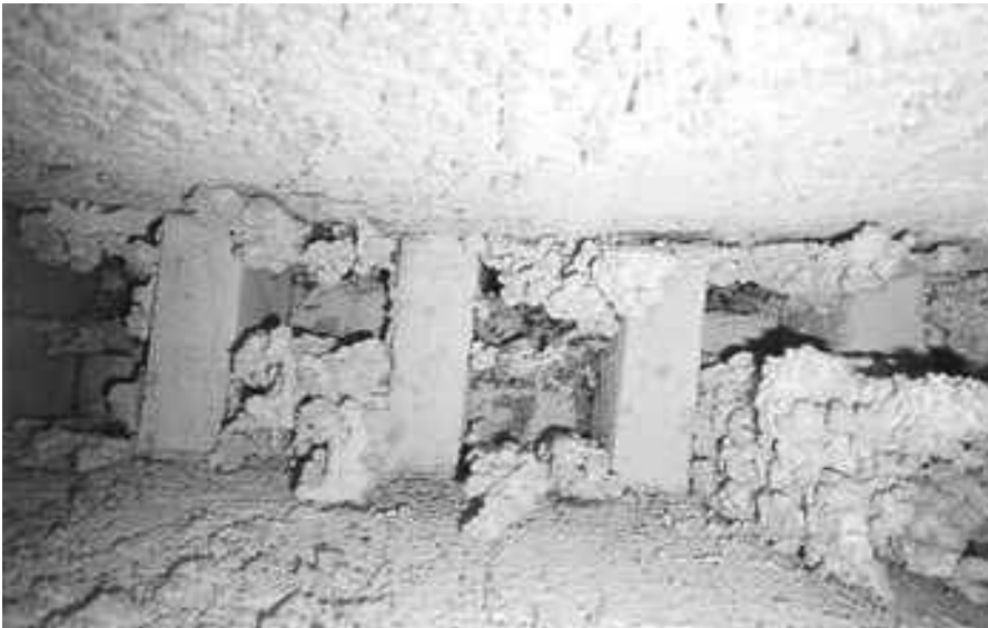
Fotoğraf 1. Finn içi tozuma nedeniyle tıkanan rejeneratör
